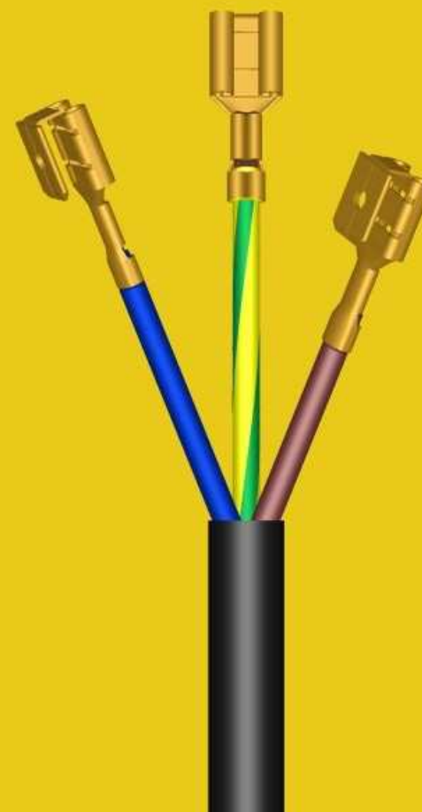
Montaż nasuwko - wsuwki
