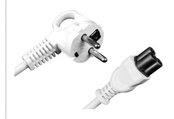
Anschlusskabel (Katalogbezeichnung SN-153 nach BIERSIN) für Geräte der Klasse I, bestehend aus einem unzerlegbaren Winkelstecker mit Griff S-15 (CEE 7/7 nach IECEE) und einem 2-poligen geraden Stecker N-3 mit Schutzkontakt (C5 nach IEC 60320), auf Kabel gepresst (siehe Tabelle unten).
